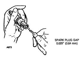
FIGURE 27. SPARK PLUG GAP
