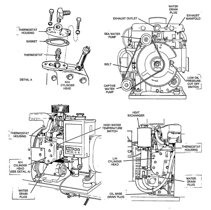
FIGURE 12. COOLING SYSTEM COMPONENT DETAILS
